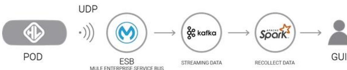
1. **Enterprise Service Bus (Mule ESB):** este componente de software está conectado a la cápsula a través de la conexión UDP. Una de sus funciones es registrar constantemente todos los datos recibidos de la cápsula. A continuación, el ESB envía los datos a través de una gran cola de datos, Apache Kafka. Este componente se ha desarrollado con Mule Enterprise Service Bus de Mulesoft utilizando Anypoint Studio.
